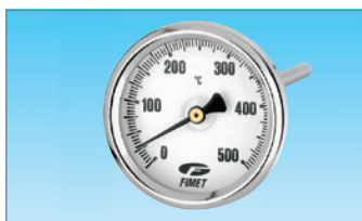
Cassa: in acciaio cromato - Trasparente: in plastica - Gambo: radiale in ottone - Elemento termometrico: spirale bimetallica - Guaina: in ottone, 1/2 - Grado di protezione: IP31
